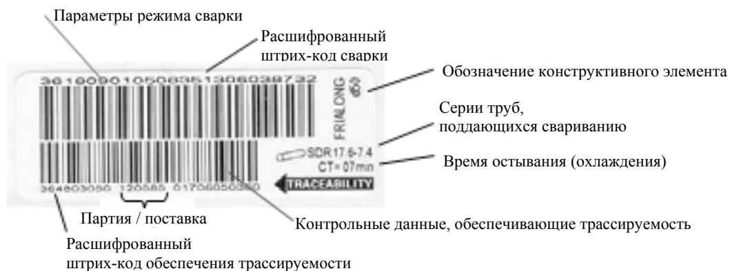
Рис. 2. Штрих-код с параметрами режима сварки и данными обратного отслеживания.
