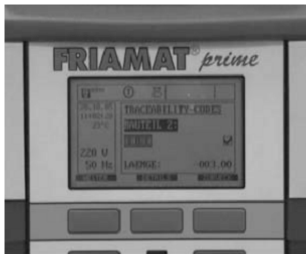
Рис. 11. Отображаемый на дисплее запрос о вводе данных для их протоколирования.
